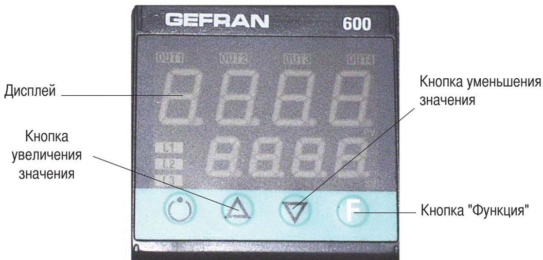
На дисплее отображается температура мазута. 4 светящихся индикатора относятся к следующим функциям: Out 1: контакт, который управляет рабочими нагревательными элементами.
