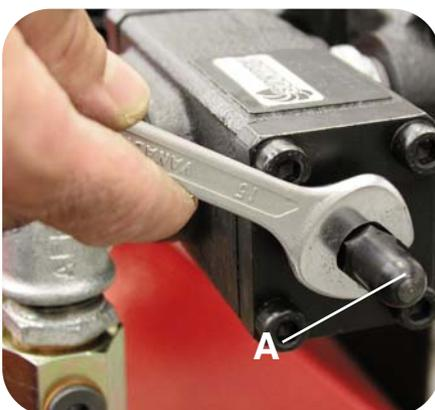
1) Снять колпачок А клапана регулировки давления TV.
