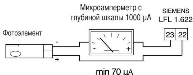
Ток ионизации проверяется с помощью микроамперметра с глубиной шкалы 1000 µA (постоянного тока), который последовательно подключается к фотоэлементу. Как правило, сила тока должна быть не ниже 70 µA.
