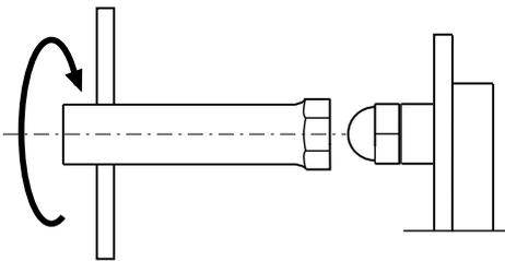
Для демонтажа форсунки пользуйтесь исключительно имеющимся в комплекте ключом. Обратите внимание на то, что бы не повредить электроды. Установите новую форсунку, при этом работу следует выполнять с максимальной осторожностью. Примечание: после замены форсунки, обязательно проверьте положение электродов (см. рис.) Неправильное положение электродов может затруднить розжиг горелки.
